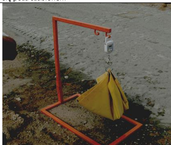
Ważenie tacki pomiarowej ze spoiwem
