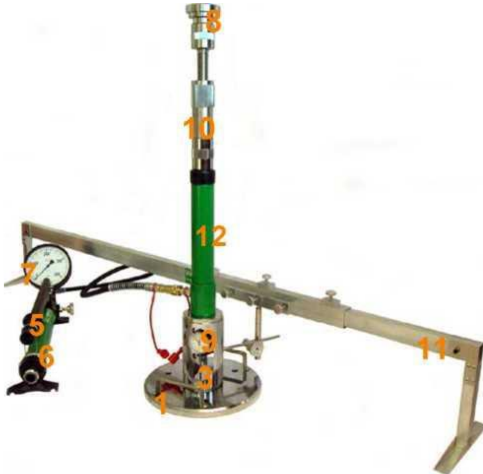
Rys. 1.2 Aparatura VSS z jednopunktowym pomiarem przemieszczenia płyty
