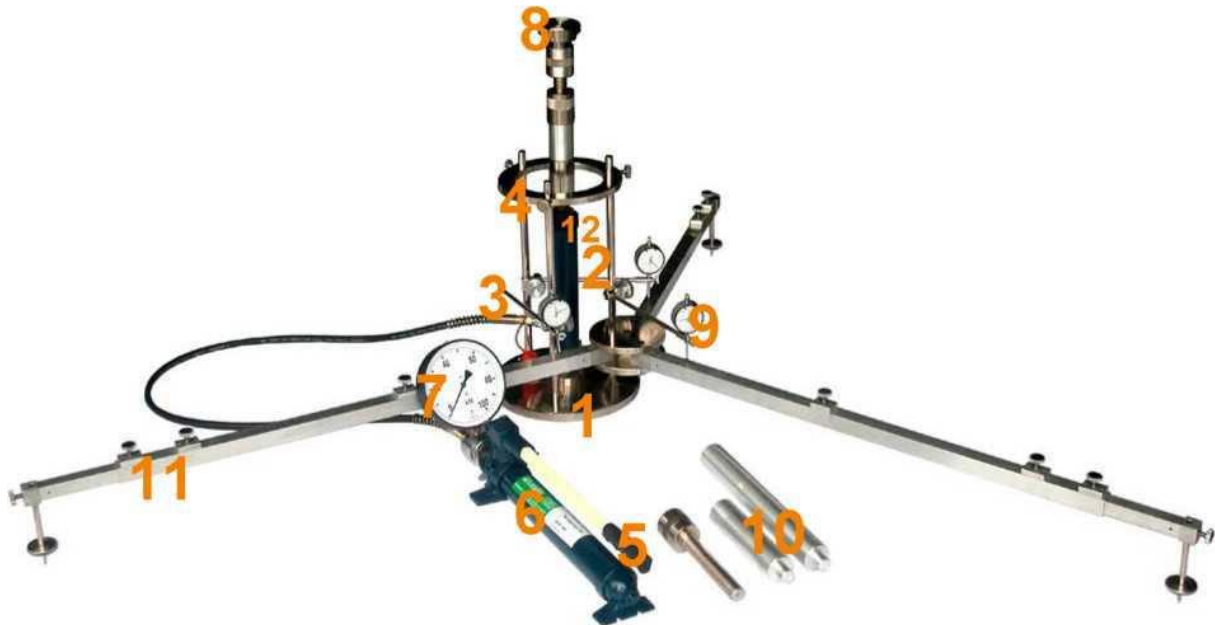
Rys. 1.2 Aparatura VSS z jednopunktowym pomiarem przemieszczenia płyty
