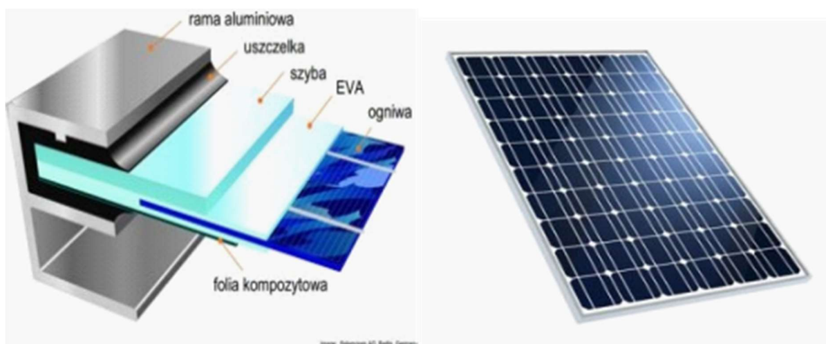
Ryc. 7. Budowa modułu fotowoltaicznego.
