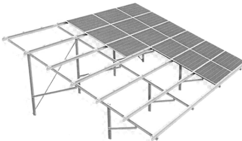
Rysunek 7. Przykładowa konstrukcja wsporcza wraz z modułami. Źródło: SYSTEM WBIJANY – DWUPODPOROWY - Energy5
